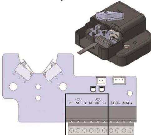
Raccorder les contacts NF (Normalement Fermé) – NO (Normalement Ouvert) – C (Commun) pour le DCU (Début de Course Unipolaire) et le FCU (Fin de Course Unipolaire).
